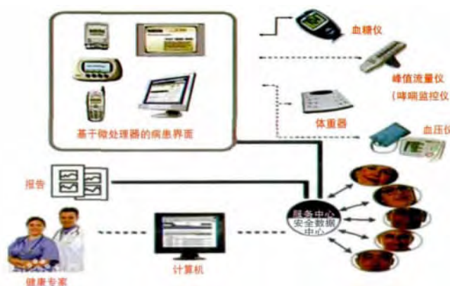
图 1 远程医疗系统的组成。①医疗服务的提供者:即医疗服务源所在地,一般位于大城市的医疗中心,具有丰富的医学资源和诊疗经验;②远地寻求医疗服务的需求方:可以是当地不具备足够医疗能力或条件的医疗机构,也可以是家庭患者;③联系两者的通信网络和诊疗装置:其中通信网络可以包括普通电话网、无线通信网以及通信卫星网等;医疗装置包括计算机软硬件、诊疗仪器等。
